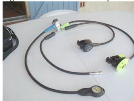
Détendeur Scubapro MK18 S550 et octopus ainsi que direct system montés sur chambre PI, le manomètre étant monté sur chambre HP
