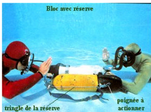
« Exercice en piscine : le plongeur en rouge a un détendeur à 2 étages monté sur le bloc avec réserve en jaune. Le bloc blanc est monté avec un détendeur à un seul étage de type Mistral »
