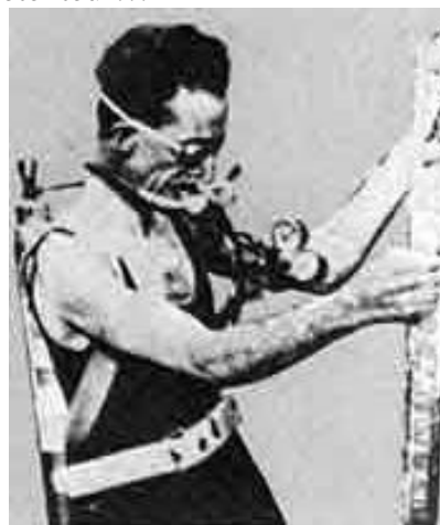
Ce scaphandre de Le PRIEUR n'a pas de régulateur à la demande. Le débit de la bouteille doit être réglé à la main.
