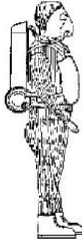
Premier scaphandre à masque de caoutchouc étanche et à circuit fermé – 1870 – à droite, masque « Fleuss » vu de face !
